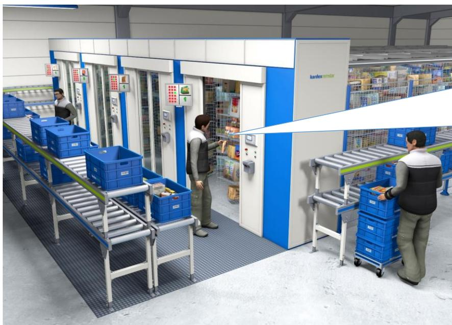
L'opérateur tape le numéro de l'article recherché sur l'écran; le carrousel se met en route et « récupère » l'article qui vient se placer devant l'opérateur. La porte s'ouvre et l'opérateur récupère l'article choisi (picking des commandes rapides et précis)
